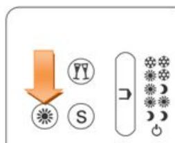
Taste mit dem *Sonnen*-Symbol drücken und *Drehknopf* drehen, bis die gewünschte **Tages**-Temperatur im Display angezeigt wird.
