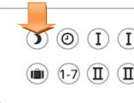
Taste mit dem *Mond*-Symbol drücken und *Drehknopf* drehen, bis die gewünschte **Nacht**-Temperatur im Display angezeigt wird.
